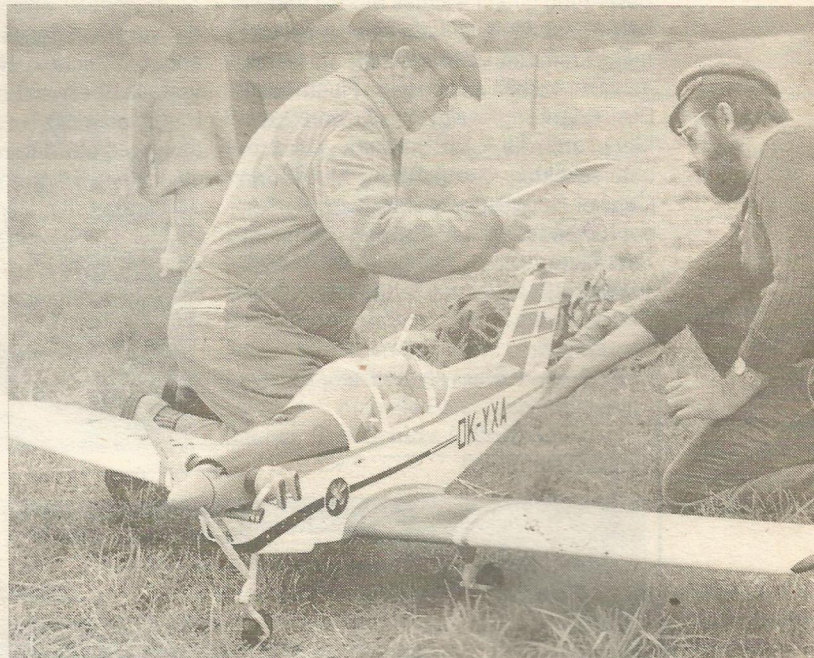
Kleine Reparatur am Höhenleitwerk der „Brouček“
